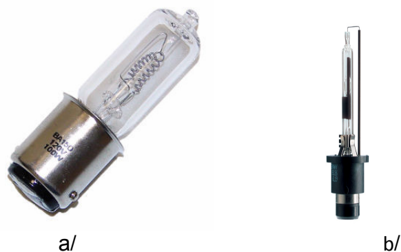
Figura 79. a/ llambë me fije të volframit, për matjen në zonën e dukshme spektrale (Vis) b/ llambë për matjen në zonën ultravjollcë(UV)
